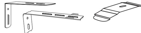
Após a instalação dos suportes, encaixe a parte de trás do trilho no suporte empurrando a parte dianteira girado para cima até seu encaixe no suporte, após ouvir o "click", cheque o nível e o alinhamento da peça.
