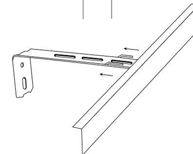
Se a Persiana tiver Acabamento de Galeria, encaixe a galeria conforme figura acima, prendendo-a no gancho.
